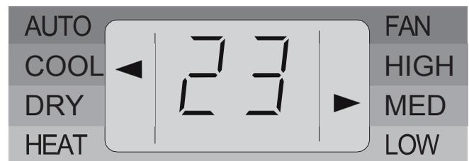
Bild 27: Betriebsart „Kühlen“ mit einer Solltemperatur von 23 °C und mittlerer Ventilatorstufe. Das Klimagerät ist ausgeschaltet.
