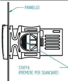
Die Tafelbau-Geräte XR60C sind für einen Ausschnitt 71x29 mm vorgesehen und werden mit zwei Befestigungsbügel fixiert. Die Befestigungsbügel von hinten aufschieben und durchschieben bis beide Bügel fest einrasten.
