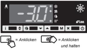
Im Alarmfall, wird der Alarmsummer durch das Drücken einer beliebigen Taste stummgeschaltet.
